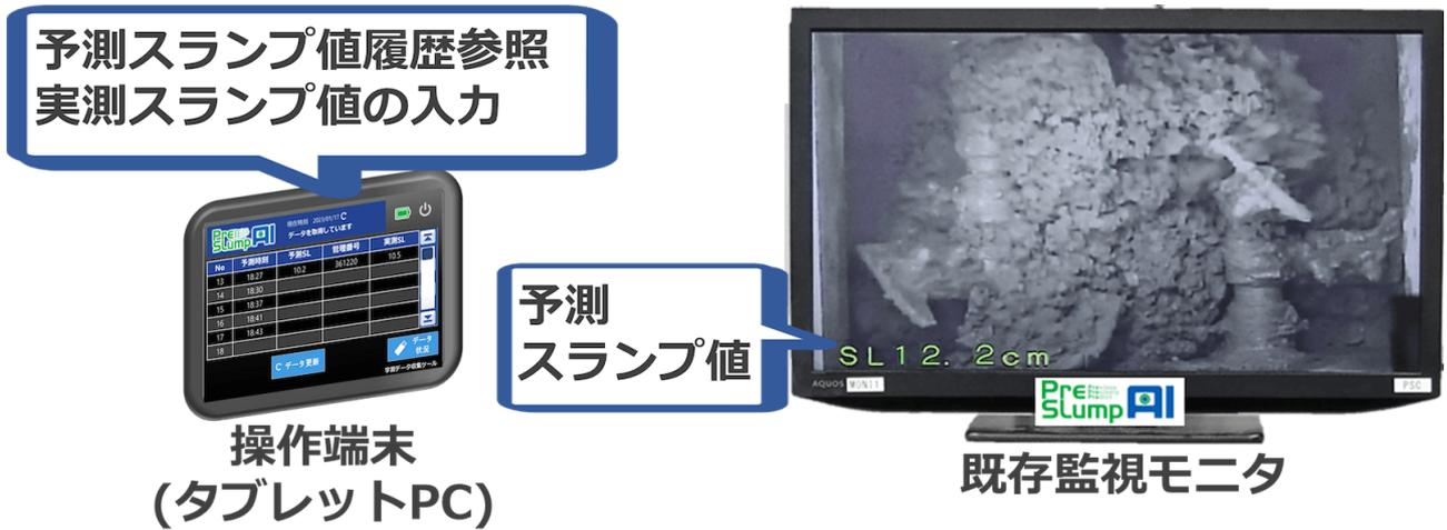
PreSLump AI®のシステム構成は、下図の通りである。その際、既存の設備を有効活用した設置が可能である。クラウドに撮影データを保存し、AIの技術向上に活用する。
